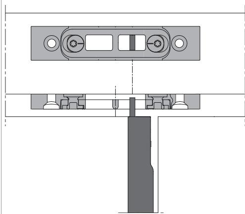
Mitte Stangenausschluss auf Kerbe ausrichten
