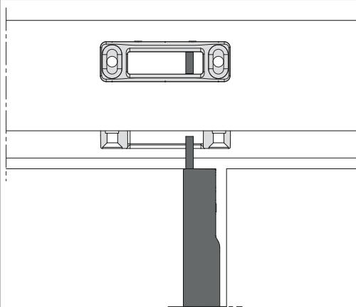
Mitte Stangenausschluss auf Kerbe ausrichten
