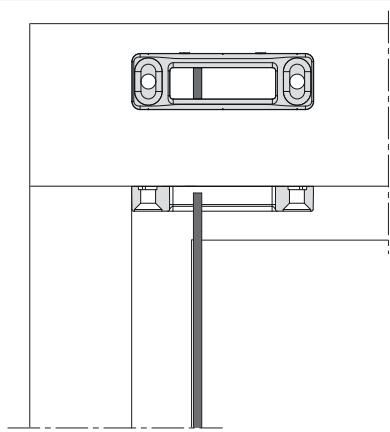
Riegelschließteil in Rahmenecke positionieren
