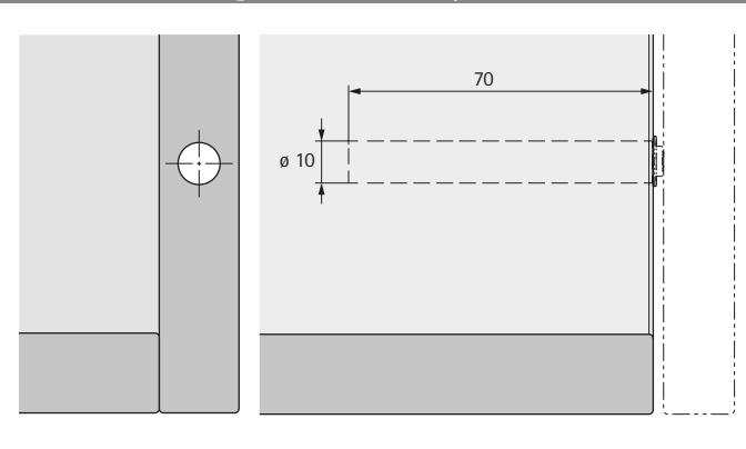
Bohrbild für Langhub, Push to open Magnet
