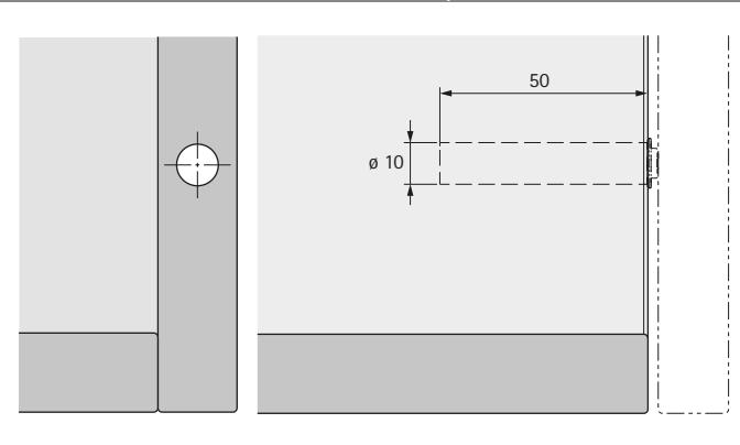
Bohrbild für Kurzhub, Push to open Magnet
