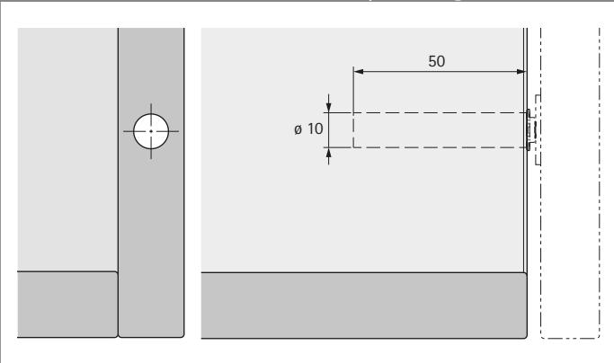
Bohrbild für Langhub, Push to open Pin
