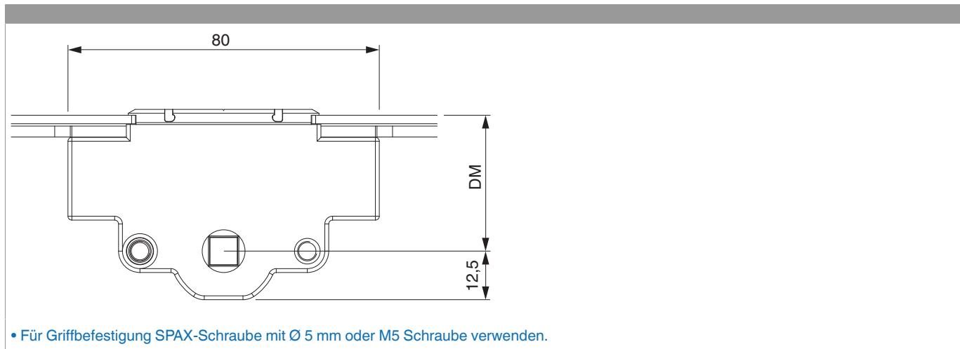
• Für Griffbefestigung SPAX-Schraube mit Ø 5 mm oder M5 Schraube verwenden.
