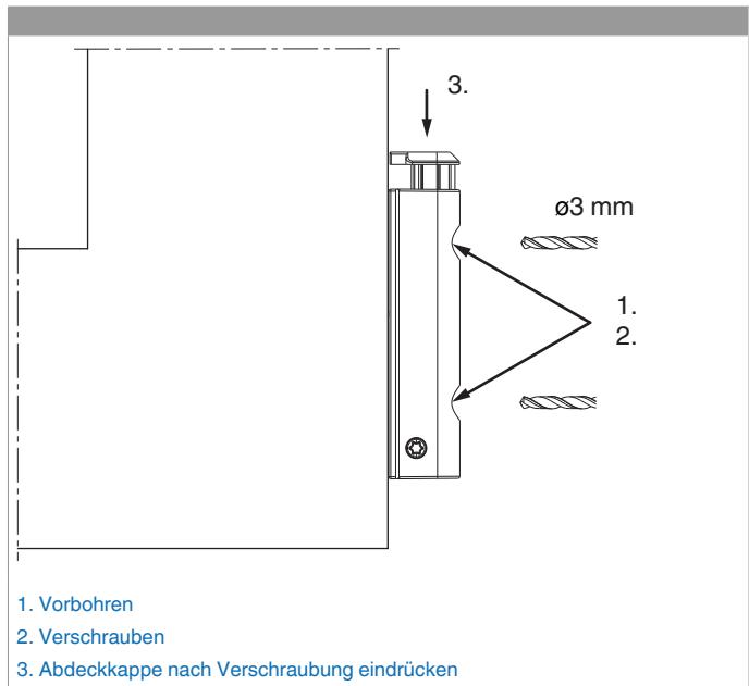
Das Ecklagerband DT mit ÜV an den Überschlag anlegen, die beiden Löcher am Überschlag vorbohren und verschrauben.
