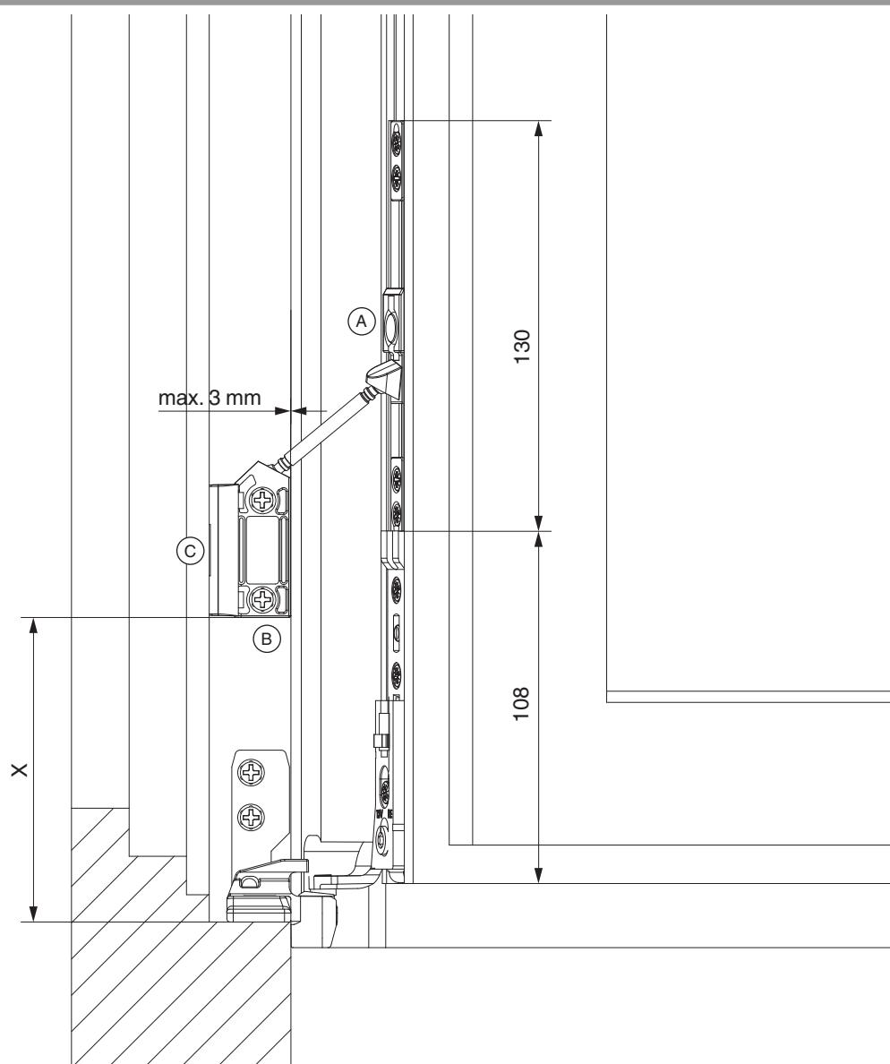
1. Flügelteil (A) laut Abbildung (108 mm von Flügelunterkante) mit Schrauben mindestens Ø 4,0 x 30 mm montieren.
