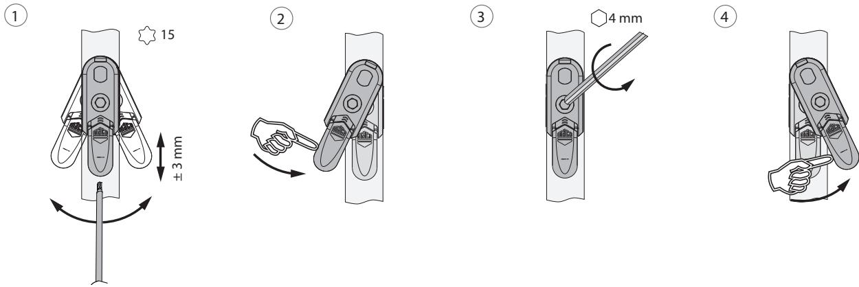
1. Ausschwenken und Höhenverstellung der Hebesicherung.
