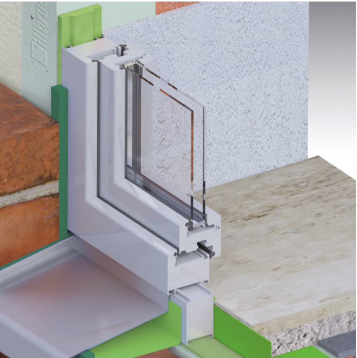
Abdichtung der Fensteranschlussfuge zum Beispiel mit Multifunktionsband
