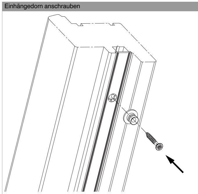
Der Einhängedorn **MUSS** mit einem Schraubloch vom Zentralverschluss mitgeschraubt werden.
