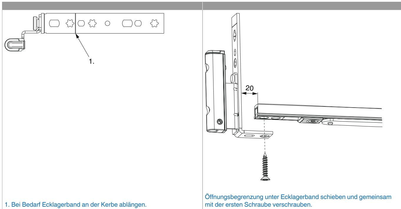
1. Bei Bedarf Ecklagerband an der Kerbe ablängen.
