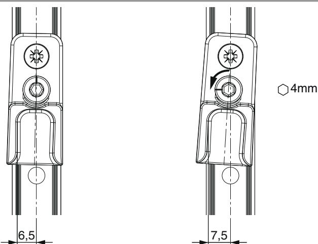
**Einstellungen:** Die Schließteile sind auf das System Euronut 6/8/4 voreingestellt und stellen sich selbst auf rechten bzw. linken Einsatz ein. Bei System Euronut 7/8/4 den Anpressdruck auf rechts bzw. links mit Innensechskantschlüssel Art. Nr. 41017 einstellen
