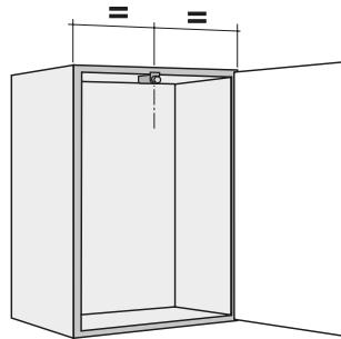
Einliegende Front: Bohrpositionen um Türdicke + 1 mm zurücksetzen
