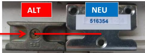
Wenn kein Blech passt, testen Sie, ob ein Eurofalzblech (unten glatt) für den Austausch genutzt werden kann. Dies muss genau positioniert und gegebenenfalls unterfüttert werden.
